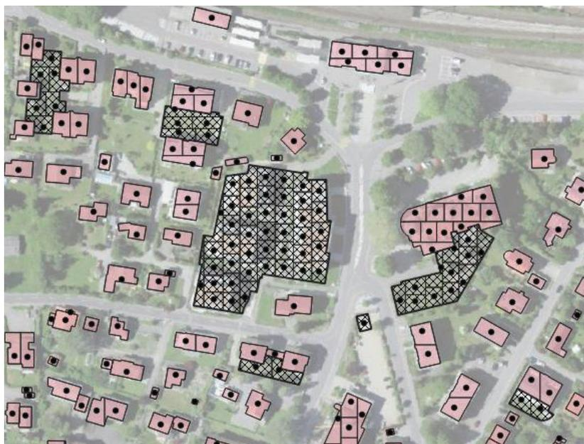
Abbildung 10: Berücksichtigung der Gebäude: Hauptfassaden (rosa), unterirdische Gebäude (schwarz kariert), Polygone mit Maximalfläche von 100 m<sup>2</sup> (schwarze Linien), Schwerpunkte der Polygone (schwarze Punkt)
