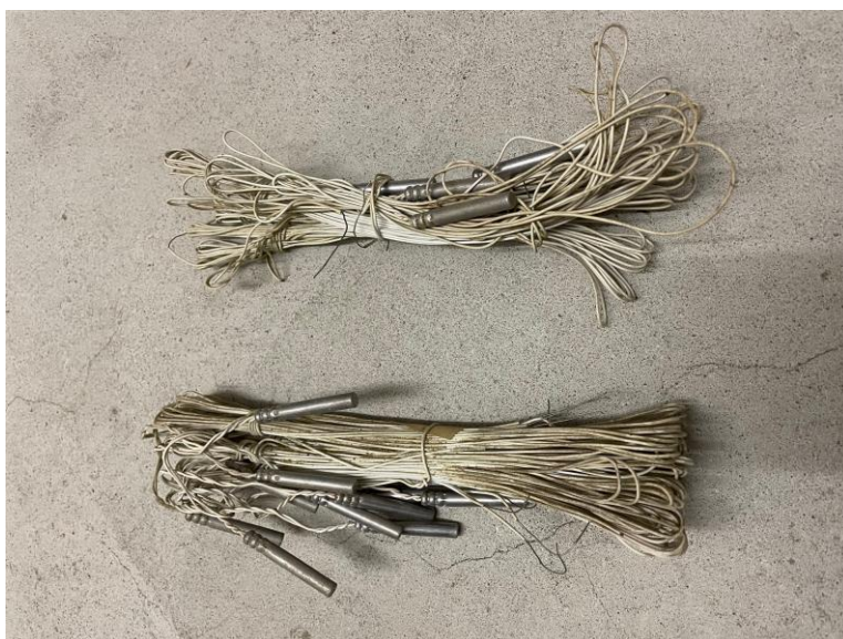
Sprengzünder elektrisch alt, sehr empfindlich
