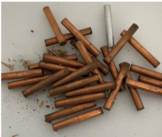
Sprengkapseln Alu und Kupfer
