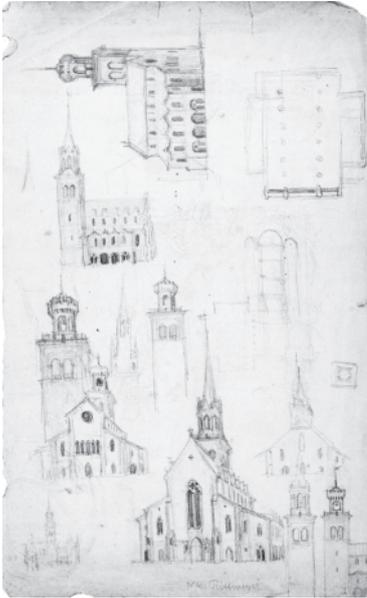
Varianten der Turmhelmprojekte zu J.G. Müllers Umbauplänen mit dem Versuch, das Mittelschiff zu «entgotisieren».
