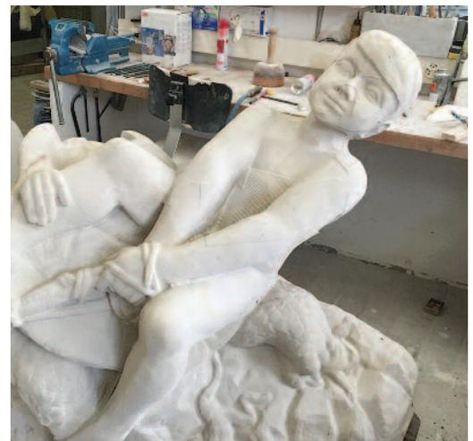
Produkt aus der Fräsmaschine. Die von der digitalen Erfassung herrührenden Reliefs Spuren sind noch gut zu erkennen und mussten von den Bildhauern überarbeitet werden.
