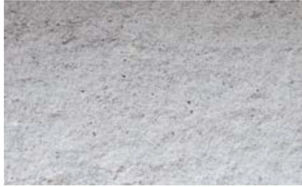
**Abb. 127 und 128** Im Steinbruch Lochmüli bei Teufen AR in der Granitischen Molasse (USM-II) liegen über dem homogenen Sandsteinkörper verschieferte Sandstein- und Mergellagen. Auf dem rund 15 cm breiten Bildausschnitt sind maximal 1 mm grosse Körner erkennbar, darunter auch rötliche Feldspäte.
