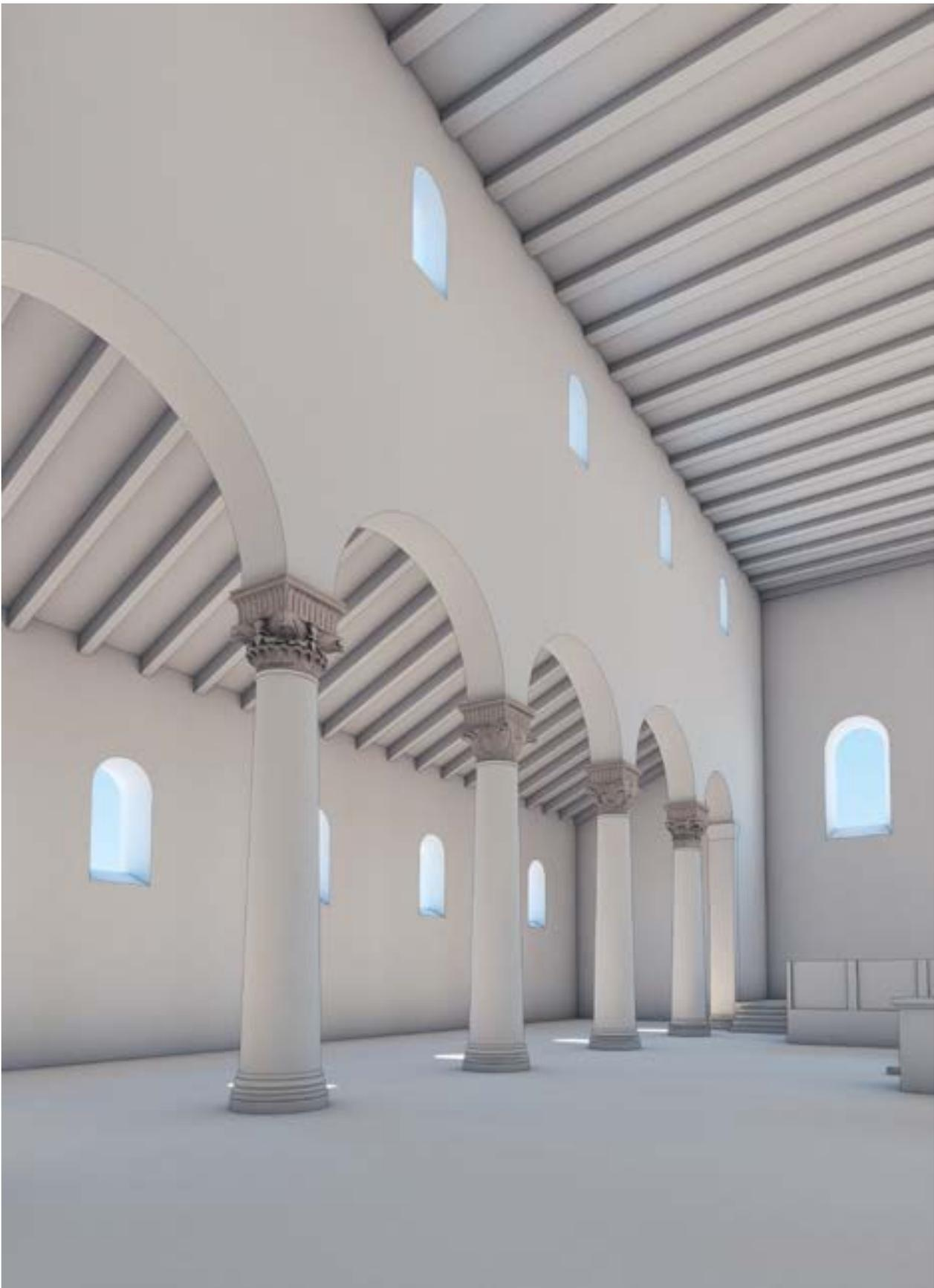
**Abb. 85.1** Kirche von Abt Gozbert, 830er-Jahre. Rekonstruktion der nördlichen Chorarkade mit vier Säulen. Die Schranke des Podiums über der Krypta und der Altar im Mittelgrund sind frei rekonstruiert. Variante ohne Postamente. Säulenhöhe: 6 m.
