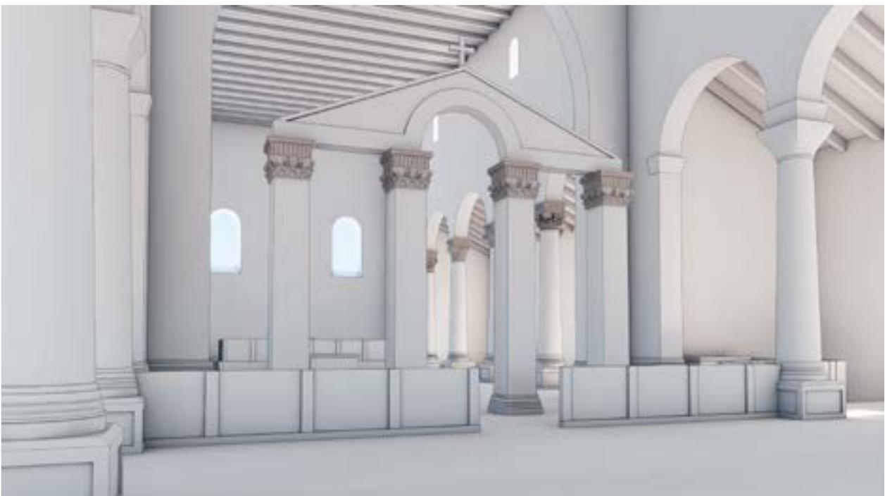
**Abb. 106.1–2** Kirche von Abt Gozbert, 830er-Jahre. Rekonstruktionsversuch. Blick aus dem Langhaus nach Osten durch die monumentale Stützenstellung in den Chor. Variante der Stützenstellung mit einem durchgehenden Giebel. Um die Höhenentwicklung des Giebels auf ein Minimum zu reduzieren, wurde auf Bögen über den seitlichen Jochen verzichtet. Die Säulenarkaden sind ohne (oben) und mit Postamenten wiedergegeben.
