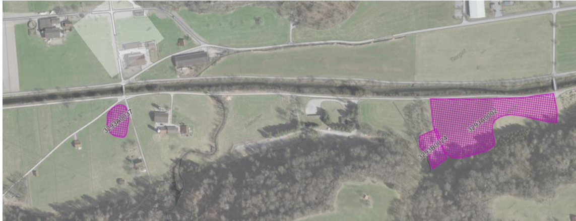
Abbildung 11: Auszug aus dem Kataster der belasteten Standorten Kt. SG, Abschnitt Seez zwischen Brücke Valeiris und Brücke Sax.
