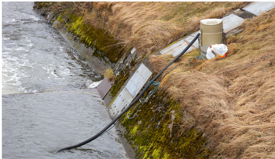
Automatisches Probenahmegerät an der Steinach zum Sammeln von Wasserproben für die Spurenstoffanalytik
