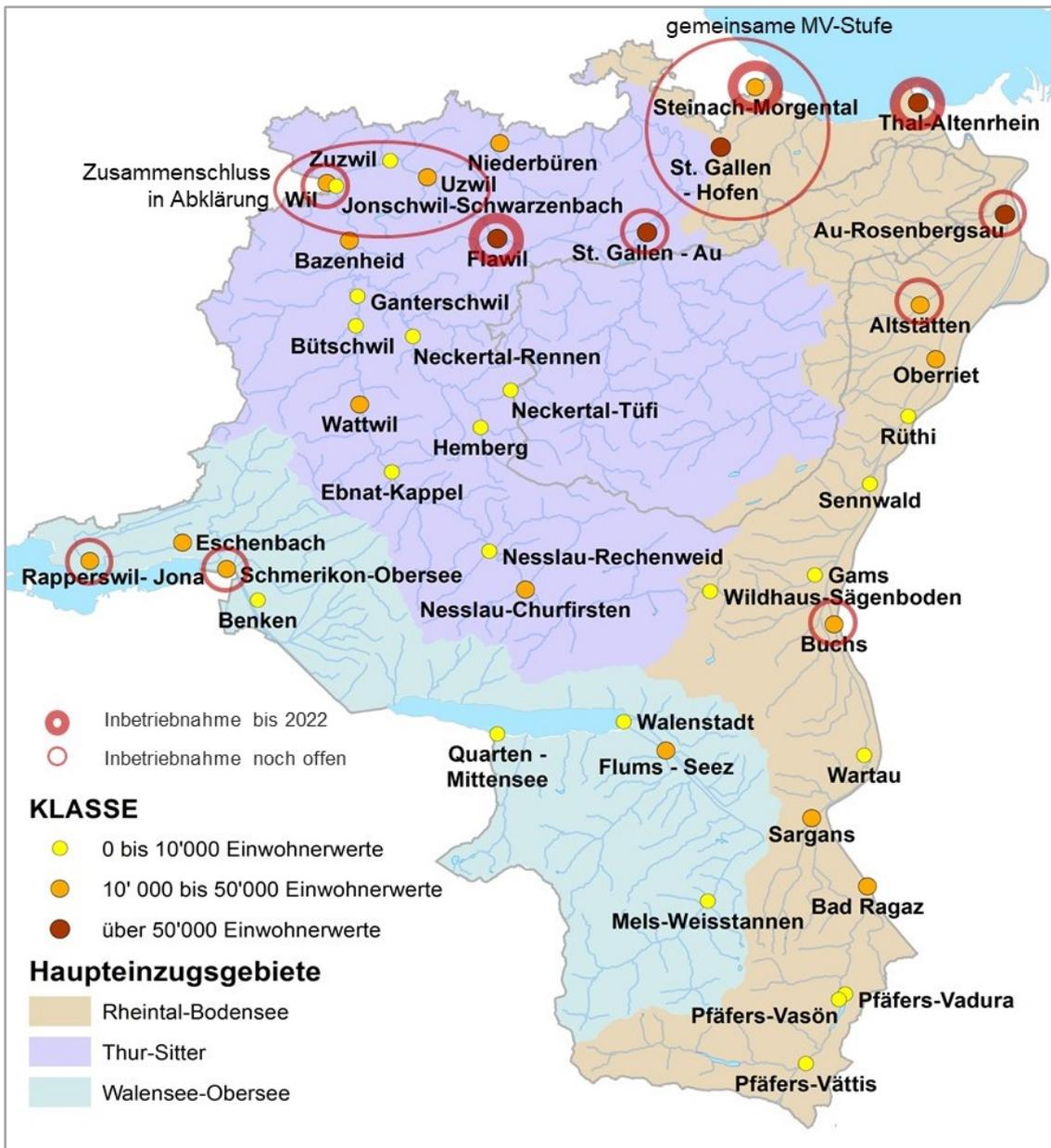
Abb. 29: Ausbau zur Elimination von Mikroverunreinigungen: Betroffene ARA im Kanton St. Gallen (Stand Dezember 2020)
