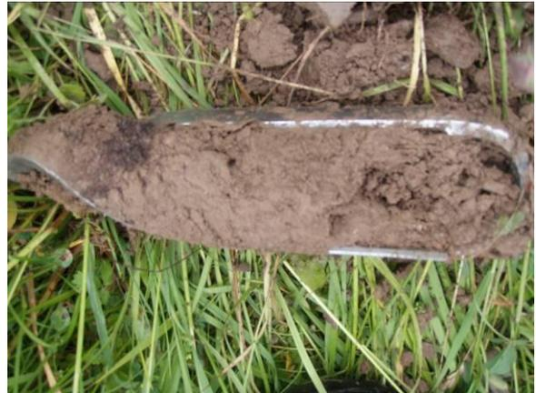
Abbildung 8: Dunkle Flecken zeigen die vernässte Schicht im Untergrund
