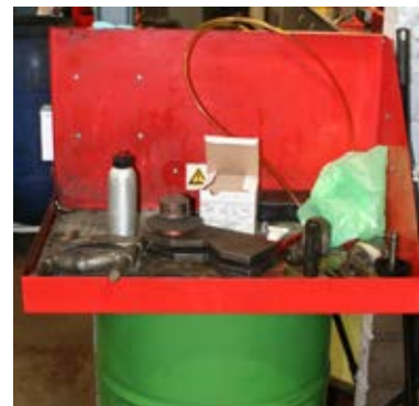
Kleinteilereiniger: Klappdeckel, die bei Nichtbetrieb geschlossen werden.
