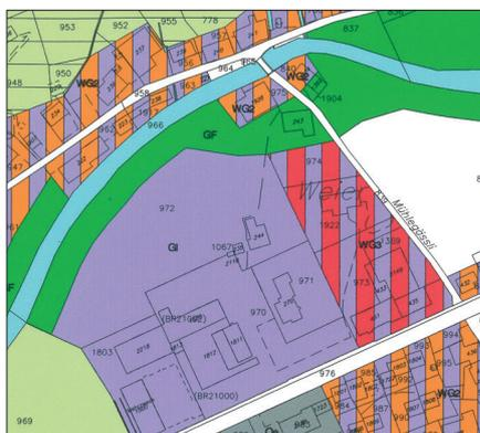
Die Gemeinde schützt sich mit raumplanerischen Massnahmen vor dem Hochwasser. Im neuen Zonenplan (rechts) wurde mit einer Grünzone sichergestellt, dass der regelmässig überflutete Durchflussskorridor freigehalten wird.
