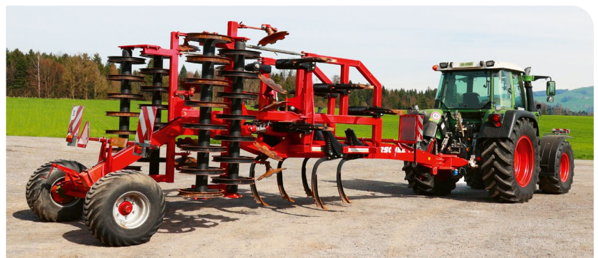
Anhänger müssen explizit für die Anhängung am Dreipunkt gebaut sein – Hilfskonstruktionen sind nicht zulässig. (Bild: BUL)
