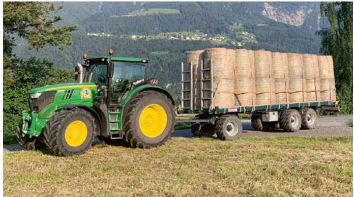
Korrekte Ladungssicherung: Jeder Ballen wird mit einem Spanngurt gesichert, gegen vorne zudem Formschluss mit stabiler Rohrkonstruktion. Bild: zVg.
