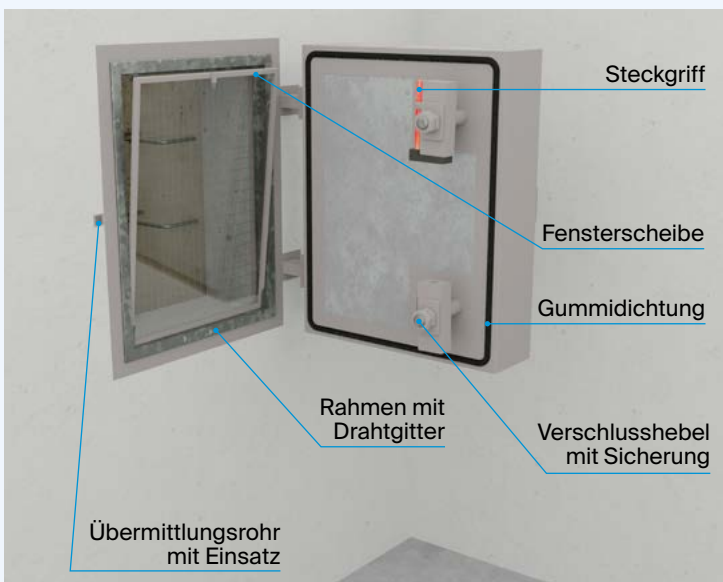
Abb. 6 Der Notausstieg wird mit dem Panzerdeckel abgeschlossen. In diesem Bereich befindet sich zudem die Luftfassung für den Schutzraum.
