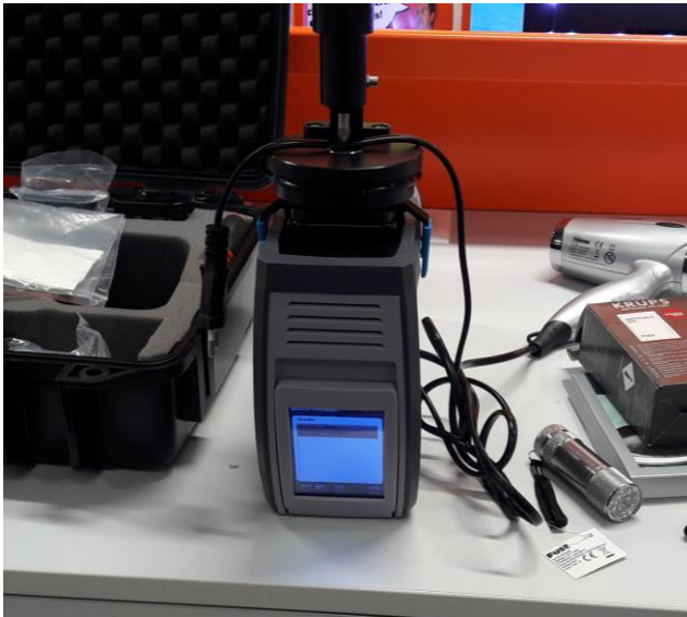
Vor-Ort-Screening eines Netzkabels auf Phthalate mittels mobilem FTIR-Spektrometer
