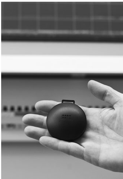
Radonmessung im Schulhaus: Dosimeter. (Bild Peter Jenni)
