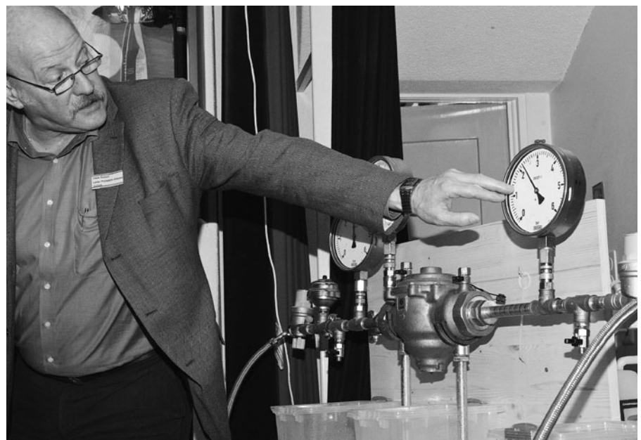
Demonstriert die Funktionsweise eines Systemtrenngerätes: Robert Haas (Leiter technische Prüfstelle Wasser beim SVGW). (Bild Peter Jenni)
