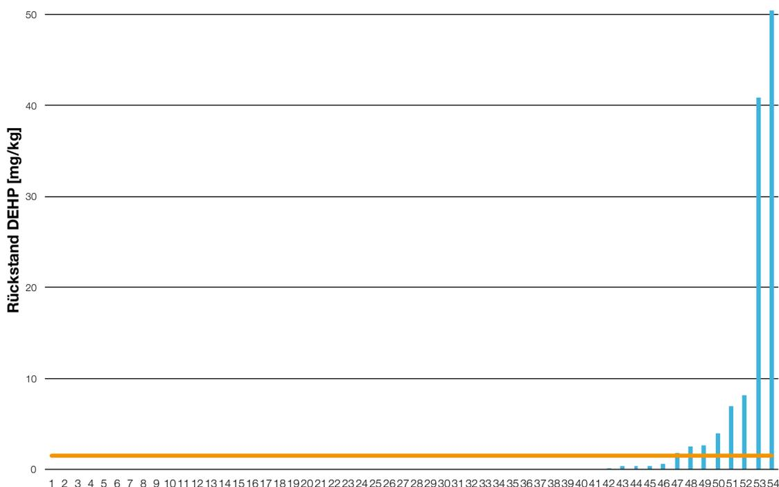
Bei einer Probe Olivenöl wurden bei der Flaschenabfüllung des Öls Schläuche verwendet, welche für den Kontakt mit Speiseöl nicht zugelassen sind. Die erhöhten Rückstände an DEHP konnten durch den Austausch dieser Schläuche verhindert werden.
