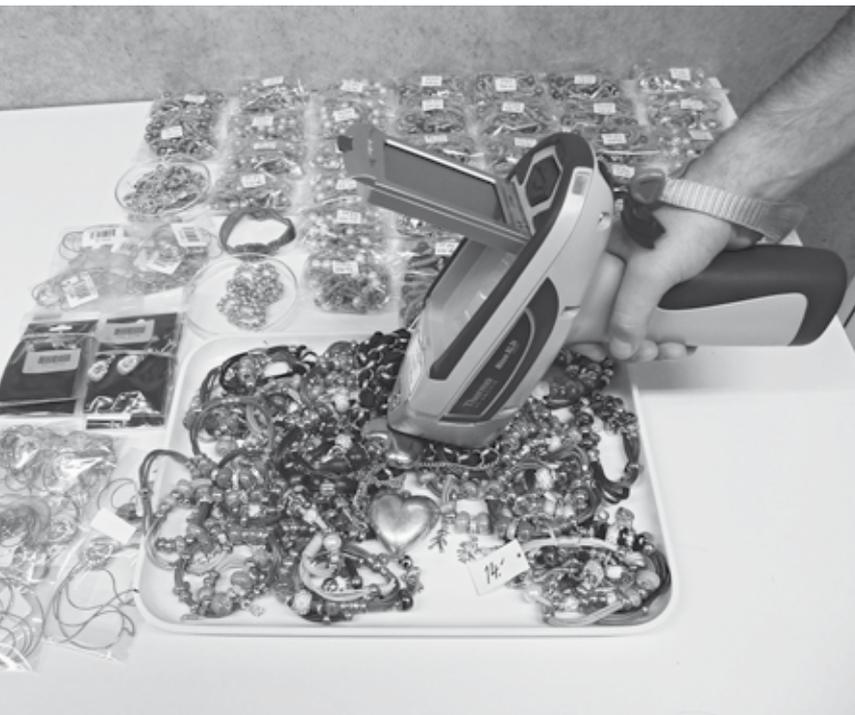
Ermöglicht die direkte Ermittlung der elementaren Zusammensetzung der Schmuckoberfläche und somit eine schnelle Überprüfung der Blei- und Cadmium-Gehalte vor Ort: Röntgenfluoreszenzspektrometer (XRF).
