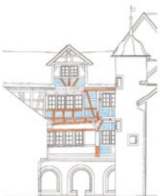
Massnahmen: in rot ersetzte Hölzer des Fachwerks, in blau die ab- und neu aufgebauten Gefache.
