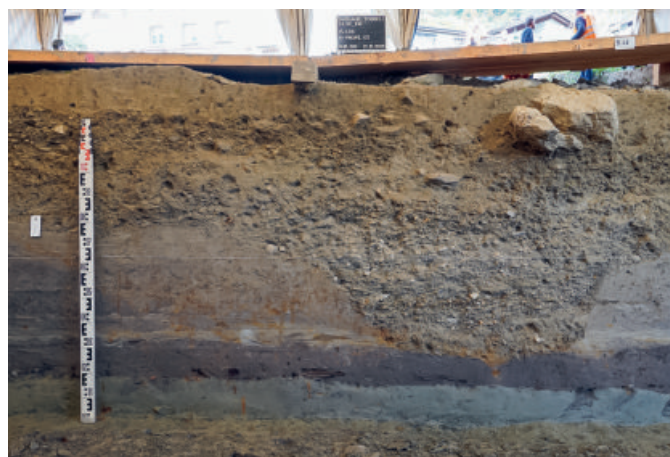
Oben: Sargans, Malerva/Töbeli, römischer Gutshof. Der Unterbau der römischen Strasse besteht aus einer Lage aus Ästen und Wurzeln. Foto KASG.
