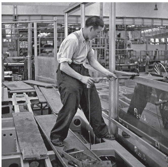
Bau von Anhängewagen der Serie C4 1401-1415 der Basler Verkehrs-Betriebe (BV), bestellt als C4 751 - 765, in der Dornier-Werke Altenrhein AG in Thal, 1947. (Bild: Werkaufnahmen Dornier)
