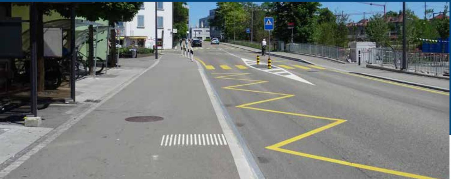
Damit bei Busbuchten kein Überstreichen der Haltekante notwendig ist und das Spaltmass zwischen Türe und Haltekante eingehalten wird, benötigt der Bus genügend Platz für die Zu- und Wegfahrt. Eine Busbucht misst daher über 70m in der Länge und benötigt rund 150m<sup>2</sup> mehr Fläche als eine Fahrbahnhaltestelle. Bei 1200 Bushaltekanten auf Kantonsstrassen ergibt sich ein zusätzlicher Flächenbedarf von 25 Fussballfeldern.
