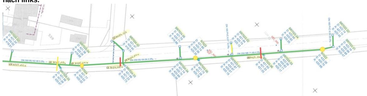
Abbildung 3: Rechter Abschnitt der Strassenentwässerung. Das Wasser fliesst von rechts nach links bis zum Schacht R7030 (Abbildung 1) und anschliessend in den Witöfeligrabe.
