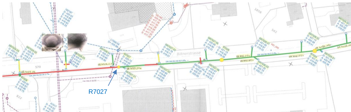
Abbildung 2: Mittlerer Abschnitt der Strassenentwässerung. Fliessrichtung des Wassers ist von rechts nach links.
