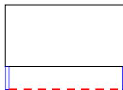
Grössere, massive Verladerampen mit einer Tiefe von > 2m sind zu erheben. Darüber hinaus ragende Vordächer sind erst zu erheben, wenn diese die Rampe um mindestens 1 m überragen.
